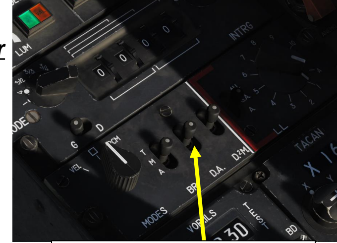
DA ( Détecteur d'Alerte ) Power Switch • T = Test • M = MARCHÉ = ON • A = ARRÊT = OFF
